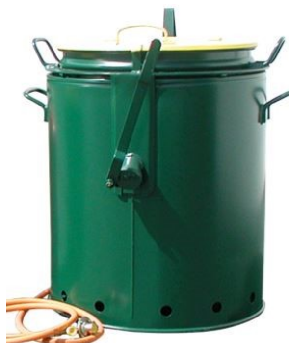
Art. nr: 620203 NOBB: Asfaltkoke 49 liter. Justerbar varme. Stengeventil for avtapping på siden. Kan varme inn til 100 l/h. Gass forbruk ca. 1,4 kg/h. Gasstrykk: 1,5 bar fast. Vekt ca. 13kg
