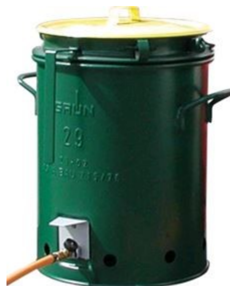
Art. nr: 620202 NOBB: Asfaltkoke 29 liter. Justerbar varme. Bøtte kan tas ut. Kan varme inn til 60 l/h. Gass forbruk ca. 0,8 kg/h. Gasstrykk: 1,5 bar fast. Vekt ca. 27kg
