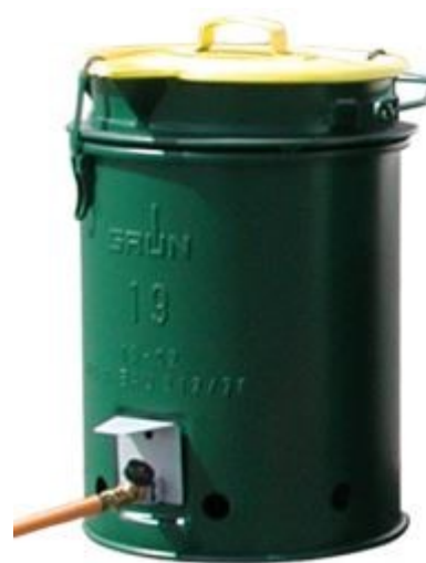
Art. nr: 620201 NOBB: Asfaltkoke 19 liter. Justerbar varme. Bøtte kan tas ut. Kan varme inn til 40 l/h. Gass forbruk ca. 0,6 kg/h. Gasstrykk: 1,5 bar fast. Vekt ca. 13kg
